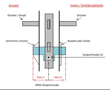
Beim <u>ausgebauten</u> Zylinder finden Sie unter dem Mitnehmer die Bohrung (Gewinde M5) für die Stulpschraube. Von der Mitte dieser Bohrung messen Sie nach aussen (Mass A) und nach innen (Mass B)
